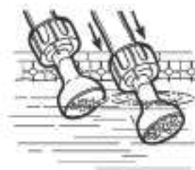
Bocca doppia funzione: per i detriti sul fondo o negli angoli.
