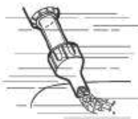
Bocca doppia funzione: per i detriti sul fondo o negli angoli.
