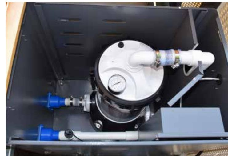
Unità filtrante con riscaldatore dell'acqua integrato
